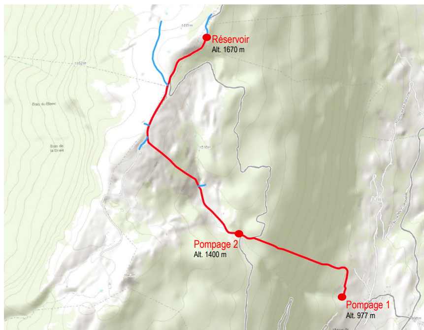
Figure 49 : Sécurisation AEP du plateau du Semnoz en Adduction / Distribution (source Montmasson 2025)
