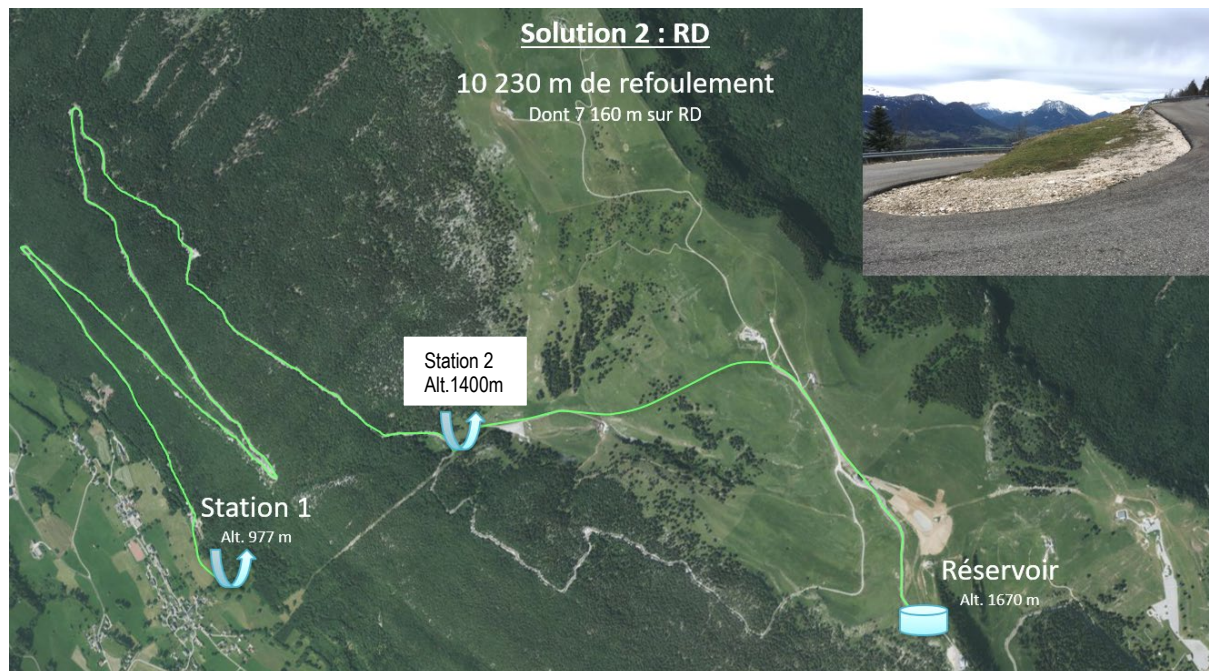
Figure 7 : Tracé du refoulement solution 2 (source Montmasson 2024)
